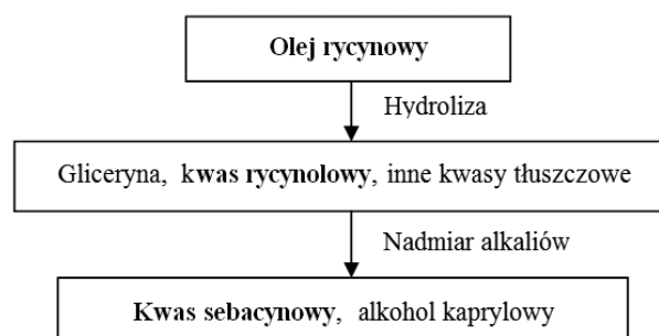
Rys. 6. Schemat otrzymywania kwasu sebacynowego z oleju rycynowego
