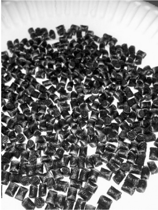
Rys. 14. Granulat EPDM/PP (50/50) Fig. 14. EPDM/PP granulate (50/50)
