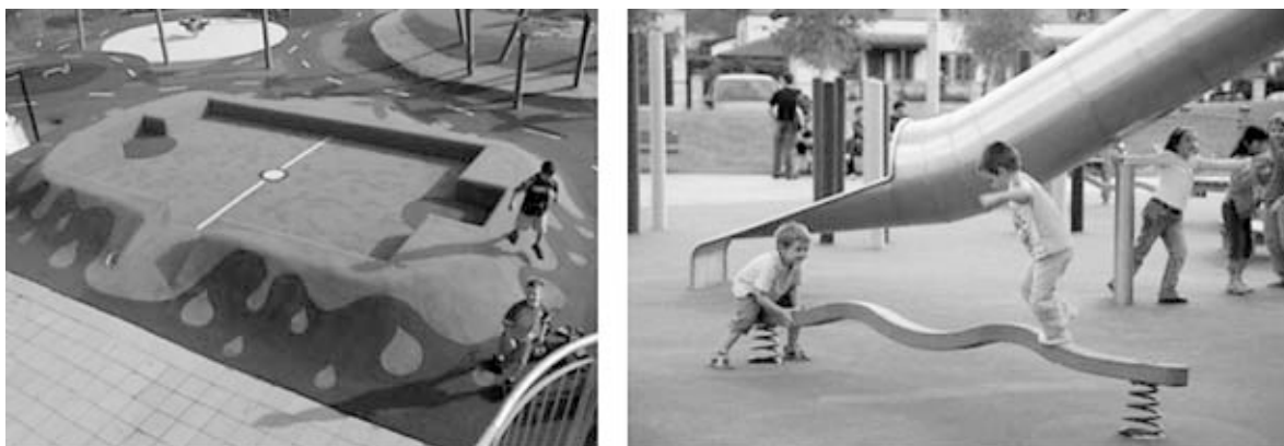
Rys. 2. Przykłady wykonania nawierzchni placów zabaw, w których jedną z warstw jest granulata gumowy (Hemet Sp. z o.o. z Zielonej Góry)
