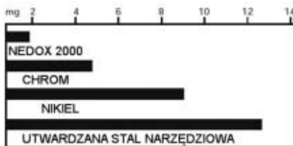
Rys. 4. Odporność na ścieranie powłoki wykonanej w procesie NEDOX w porównaniu z pokryciami wykonanymi innymi technikami (strata masy w mg na 1000 cykli – tarcza CS10) [8]
