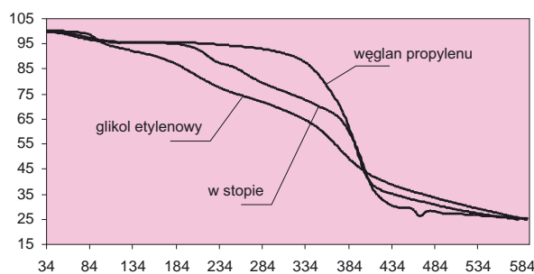
Rys. 6. Krzywa termograwimetryczna poli(kwasu asparaginowego)
